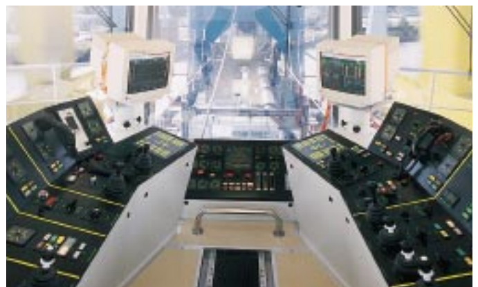
Stuurhut inclusief de automatische regelsystemen van de snijkopzuiger 'Al Mirfa'.
