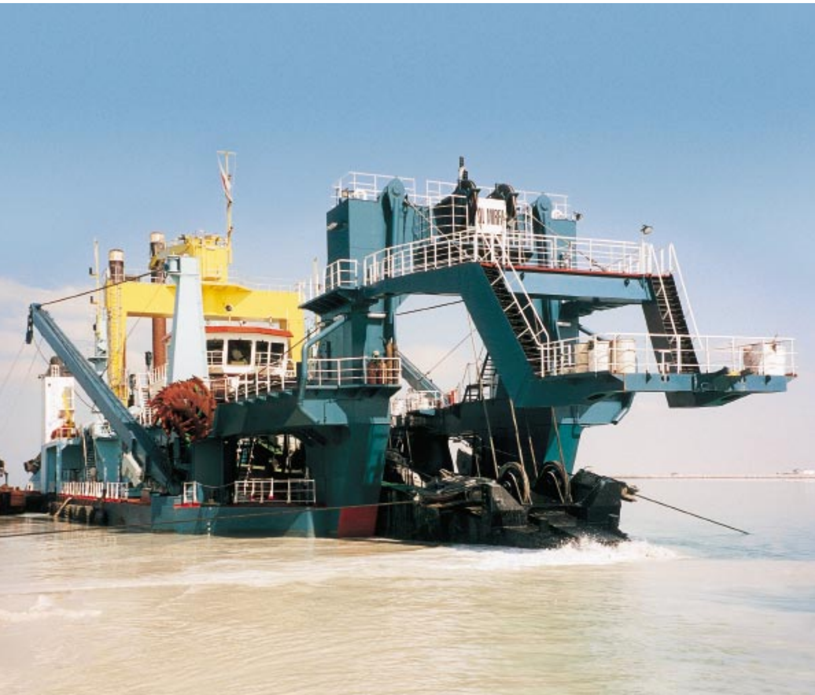
De volledig geautomatiseerde 10500 kW snijkopzuiger 'Al Mirfa', gebouwd voor NMDC, Abu Dhabi.
