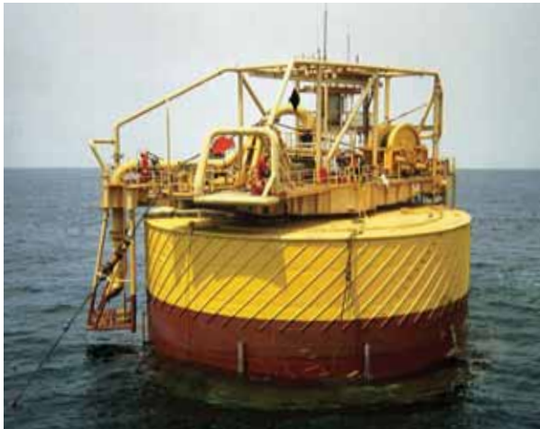
De CALM boei op het Girassol-veld geïnstalleerd in het tot nu toe diepste water (1320 meter) voor de kust van Angola, afgemeerd met polyester afmeerlijnen.
