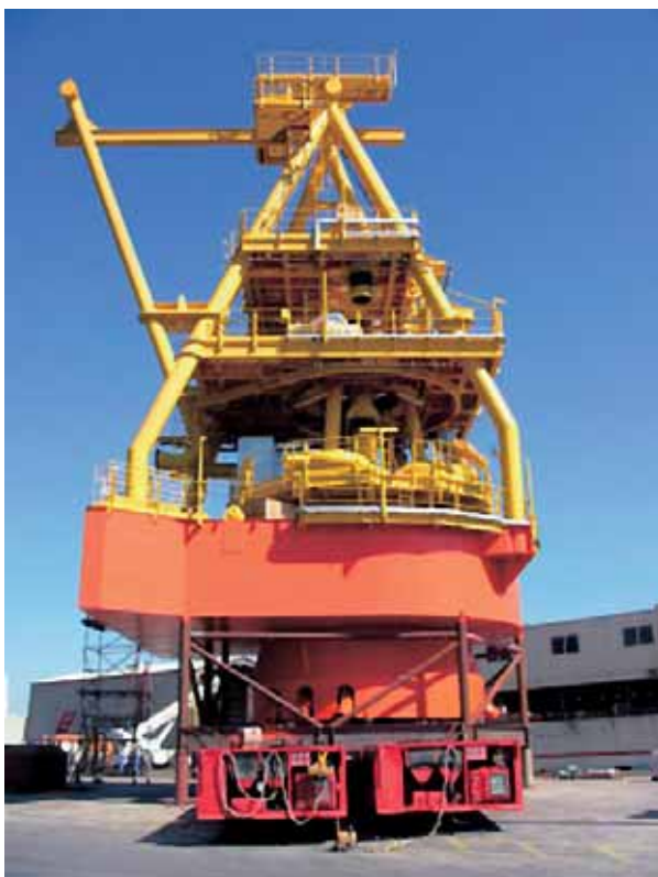
De 'turret' voor de Amenam FPSO op de werf in Abu Dhabi.
