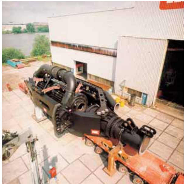
Speciaal ontworpen onderwaterpomppunit van de sleephopperzuiger 'HAM 318'.
