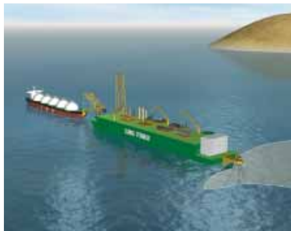
SBM's concept voor een drijvende hervergassingseenheid (FSRU), een import-terminal voor LNG.
