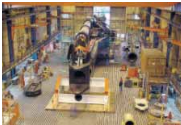
Diepwinstallatie voor de sleephopperzuiger van 44000 m 3 (na verlenging) 'Vasco da Gama' voor J. de Nul.
