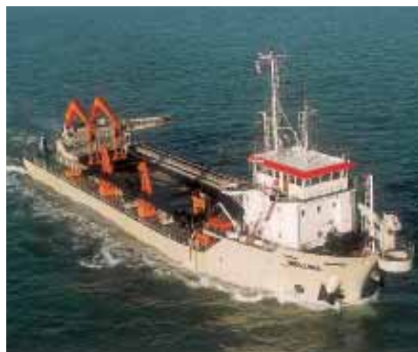
De 3000 m 3 zeegaande zand- en grindzuiger 'Mellina'.
