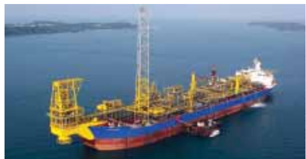
De Yoho FPSO gereed voor installatie buitengaats Nigeria; de eerste van de serie generieke FPSO's voor ExxonMobil, sinds november 2002 in de verhuur.
