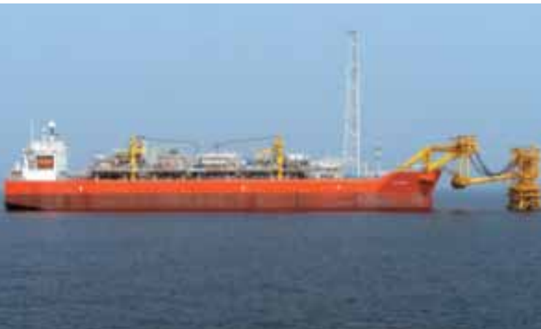
Aanzicht van de Shell EA FPSO verbonden met het door SBM geleverde afmeerplatform met een flexibele arm.
