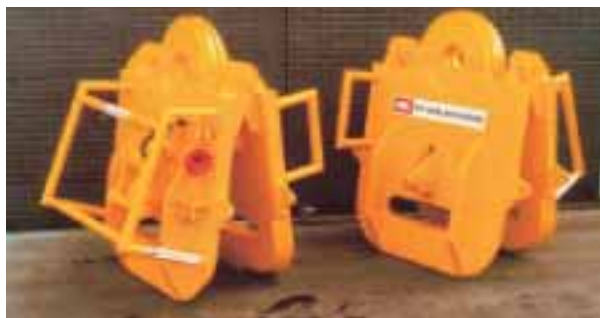
500 tons paalklemmen voor de installatie van ankerlijnen voor de Spar 'Vastar Horn Mountain'.
