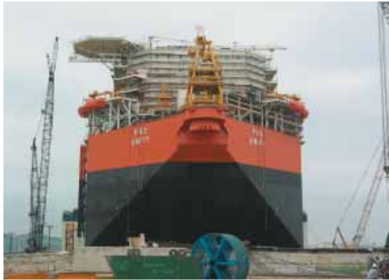
De FSO Unity, een 'turnkey' opdracht voor TotalFinaElf Nigeria. Deze VLCC tanker werd op de wal geassembleerd en uitgerust bij Hyundai en vanaf de kade te water gelaten – een unieke methode voor een schip van deze omvang.
