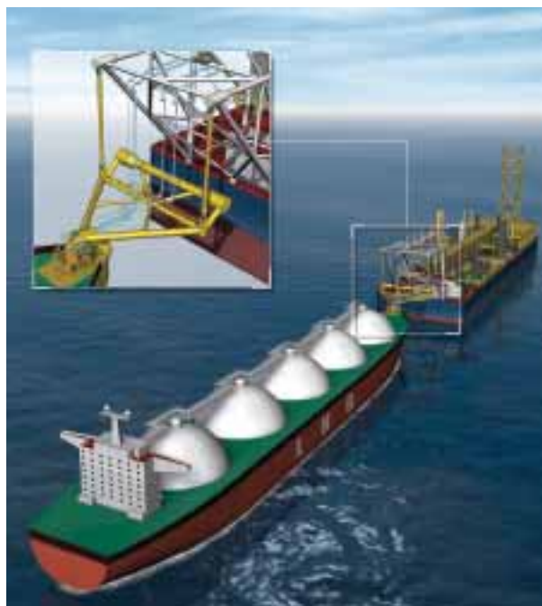
Een computertekening van de SYMO®-technologie, toegepast voor het in tandem laden van gastankers vanaf een drijvende LNG productie-installatie.
