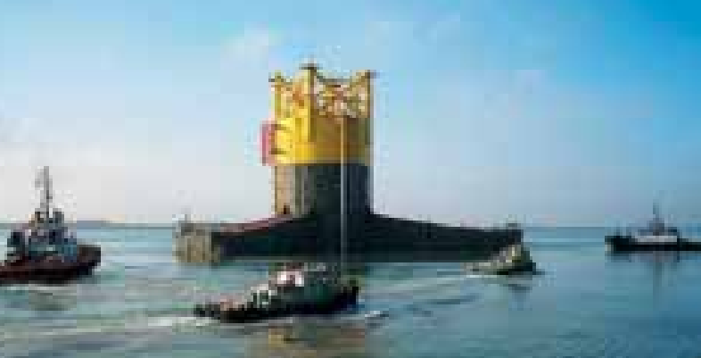
De kolom voor de Matterhorn TLP, op haar sleepreis van Singapore.
