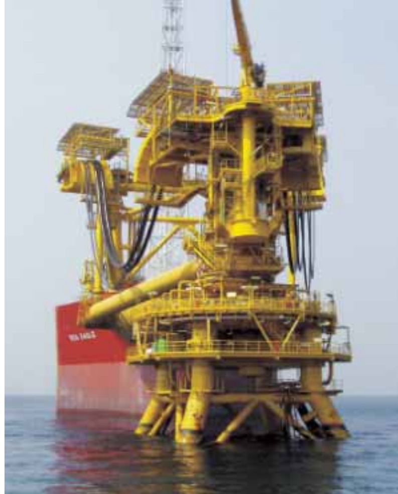
Het speciale afmeerplatform met een flexibele arm (Jacket Soft Yoke) voor zeer ondiep water, bestemd voor Shell EA.
