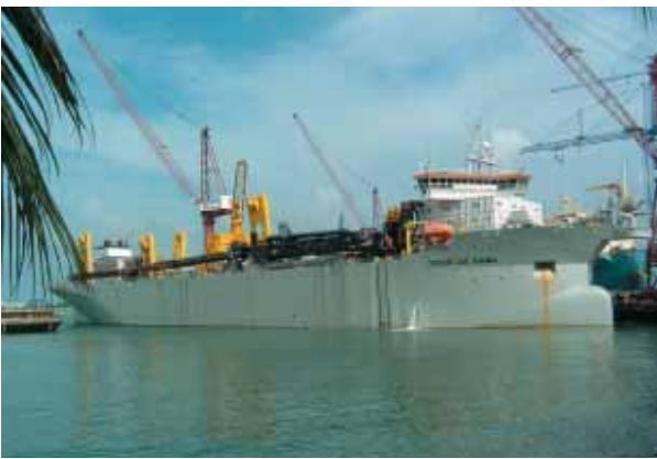
Diepwininstallatie op de 'Vasco da Gama' in Singapore
